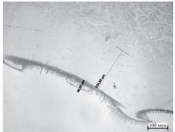
Рис. 2. Фотография линии сплавления с измеренными значениями толщин диффузионных прослоек
